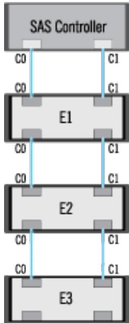
如果连接器与第一个机柜间的通信信道丢失，冗余路径配置也会丢失。在此情况下，逻辑连接器的运行状况显示为严重。导航至逻辑连接器的信息/配置页面，查看[路径运行状况](#)的详细信息。有关此情况的简要概述，请参阅下表：
